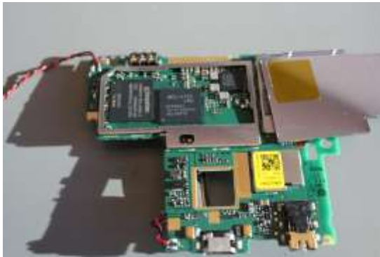
Acer z520 mit eMMC/MCP -> DRAM + Flash mit 221 BGA Aufbau
