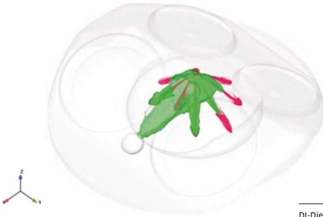
DI-Diesel Brennverfahren mit später Wasserstoffbeimischung - Diesel (rot), Wasserstoff (grün), Einloch-Injektor, Kurbelwellenposition 9 vor dem oberen Totpunkt
