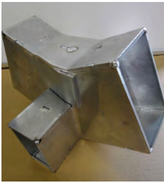
links: Aluminiumblechknoten (EN-AW 6016) aus 10 Teilen mit Wandstärken von 2/3/4 mm
