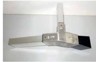
links: Klebeverbindungen: CFK-Alu/GFK-Alu (links), Stahl-Stahl/Alu-Alu (Mitte), Stahl-Alu/Alu-Alu (rechts)
