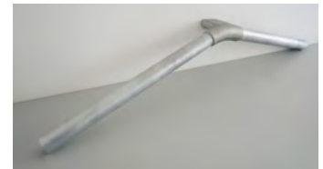
Vorderwagenstruktur mit eingegossenem Alumi- niumlängsträger und Über- gangsträger aus Stahl
