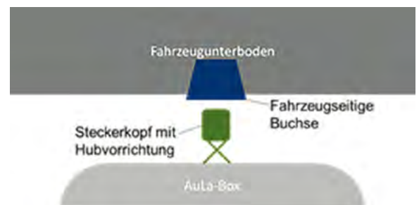
Prinzip des automatisch-gekoppelten Ladevorganges
