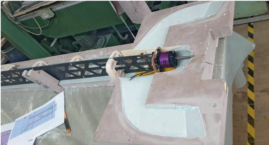
Halbschale des Seitenleitwerks und Trägers des Flugdemonstrators inklusive Montageplatte und Schubmotor
