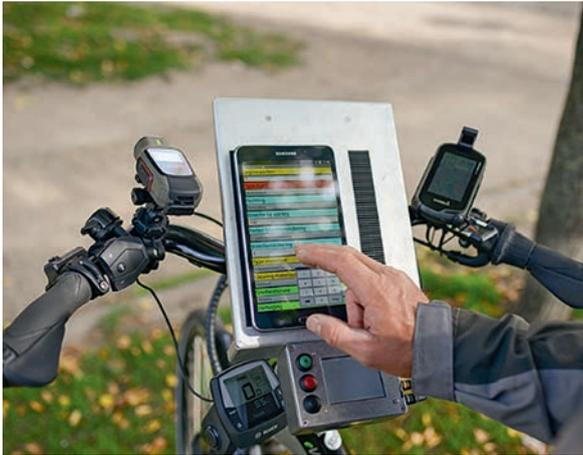
**Messfahrrad:** Erfassung von (Un-)Ebenheiten und einzelnen Oberflächenschäden in einer Messlinie
