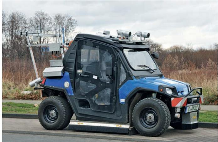
**Messfahrzeug:** Erfassung von (Un-)Ebenheiten und Oberflächenschäden auf der gesamten Fläche des Radweges sowie von Merkmalen im Straßenraum (Lichtraum, Breite etc.)
