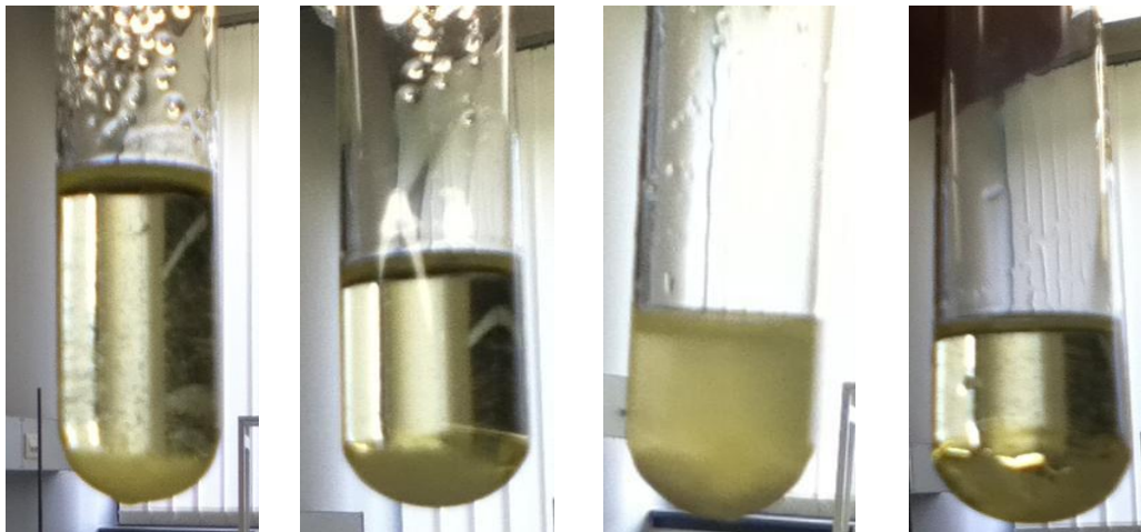
Bild 3-12: Löslichkeitsversuche von links nach rechts: NaCl, \text{KNO}_3 , \text{BaSO}_4 , NaOH
