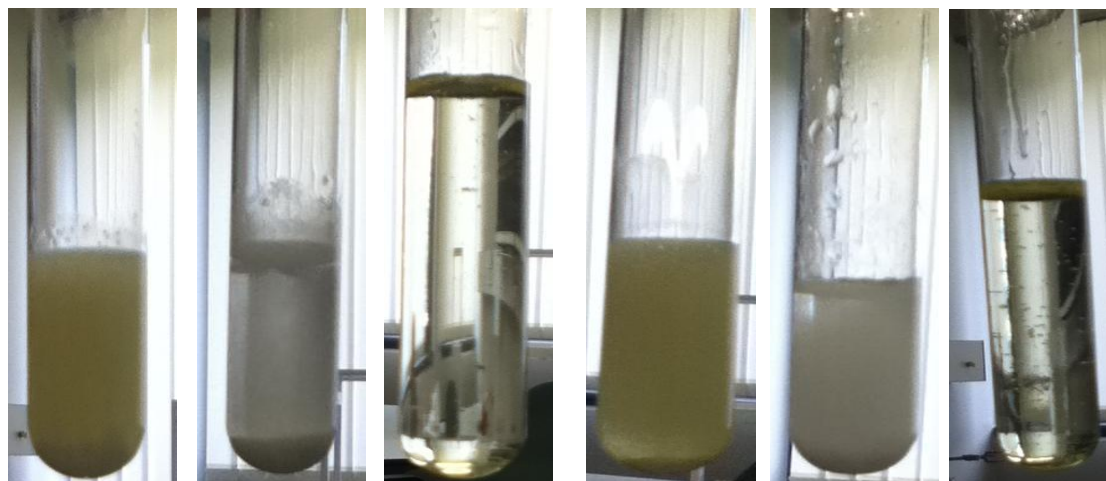
Bild 3-13: Löslichkeit gegenüber Carbonate von links nach rechts: IL + \text{BaCO}_3 , \text{H}_2\text{O} + \text{BaCO}_3 , IL + \text{BaCO}_3 + \text{H}_2\text{O} , IL + \text{CaCO}_3 , \text{H}_2\text{O} + \text{CaCO}_3 , IL + \text{CaCO}_3 + \text{H}_2\text{O}
