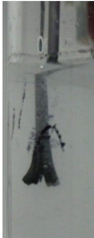
Abbildung 4-24: Foto der Aufspaltung der Graphitelektrode während der Elektrolyse
