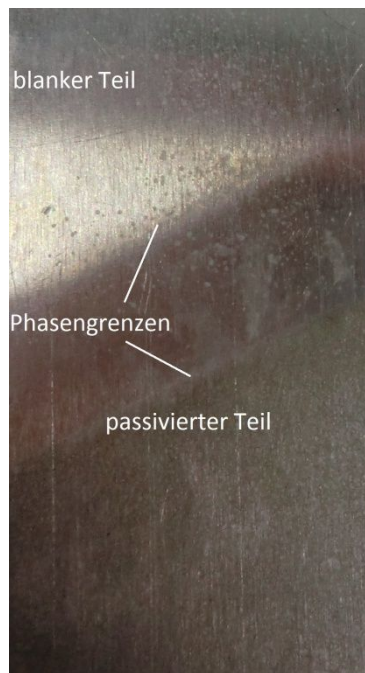
Abbildung 4-10: Abbildung einer Aluminiumelektrode nach Elektrolyse mit Veränderung der Oberfläche durch Passivierung
