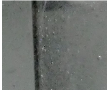
Abbildung 4-3: Bild der Gasentwicklung an einer Magnesiumkathode
