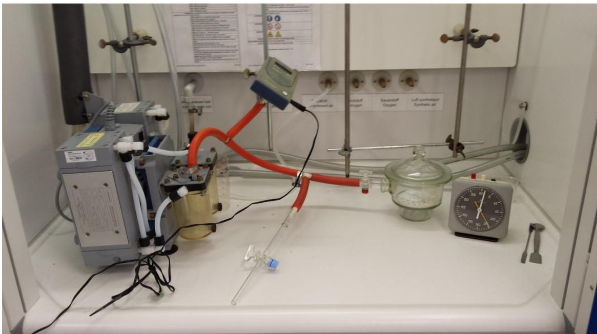
**Abbildung 13: Aufbau der Gasphasenabscheidung im Vakuum**
