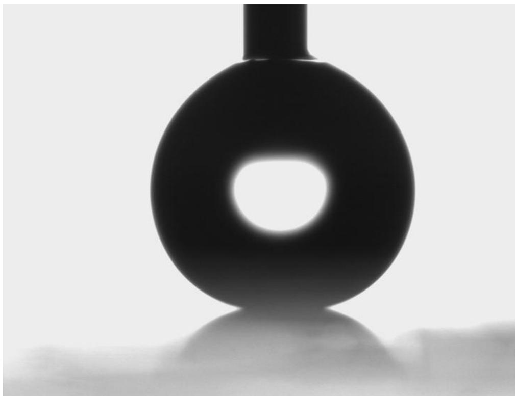
Abbildung 29: Probe 9 b. Kontaktwinkel mit Wasser
