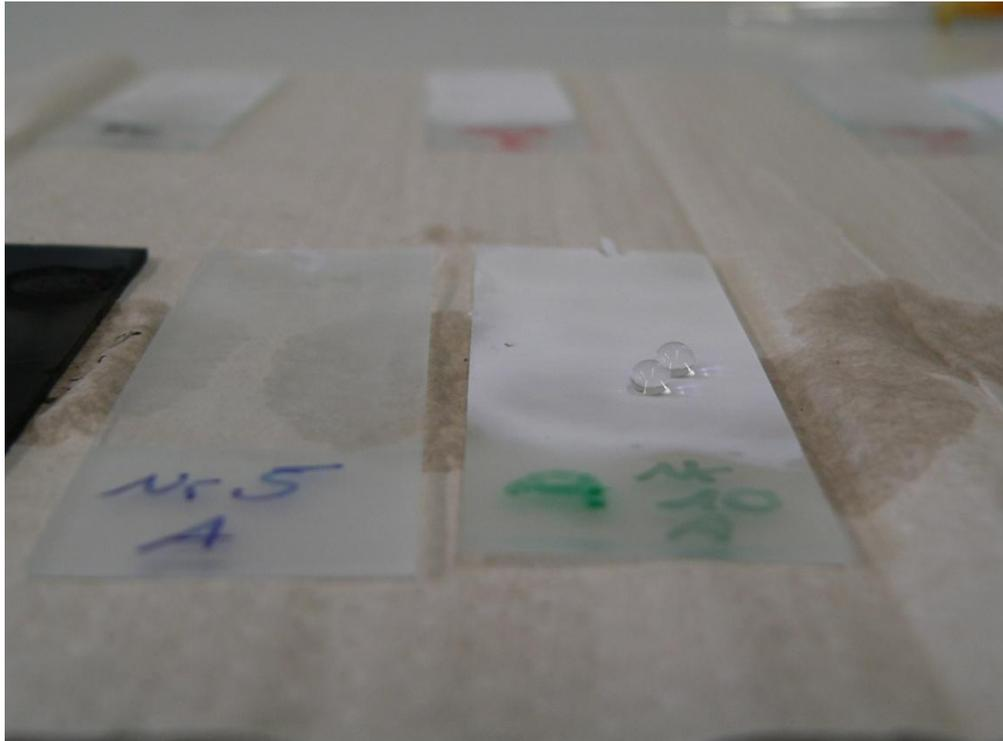
**Abbildung 26: Vergleich SiO<sub>2</sub>-Netzwerk und dem Endprodukt. Probe 10 A ist mit FTS beschichtet und superhydrophob. Probe 5 A besteht aus einem SiO<sub>2</sub>-Netzwerk und ist superhydrophil.**
