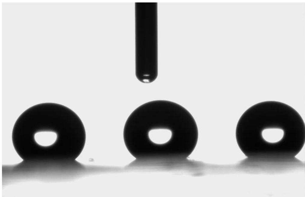
Abbildung 31: Probe 9 A. Kontaktwinkel mit Dekan
