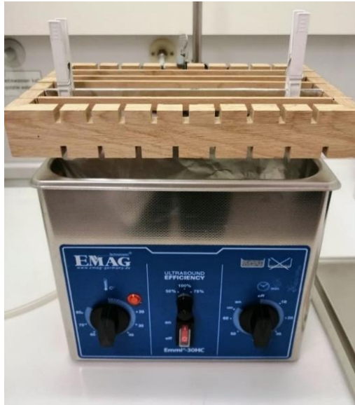
Abbildung 3-1: Versuchsaufbau – Perforation von Aluminiumfolie (Eigene Aufnahme)
