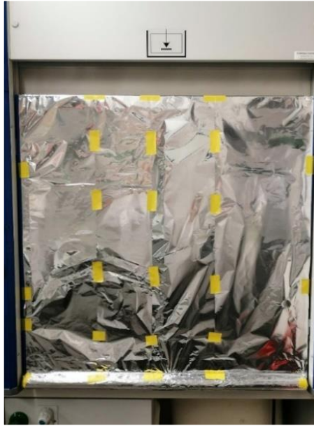
Abbildung 3-3: Verdunklung des Abzugs mit Aluminiumfolie, (Eigene Aufnahme)
