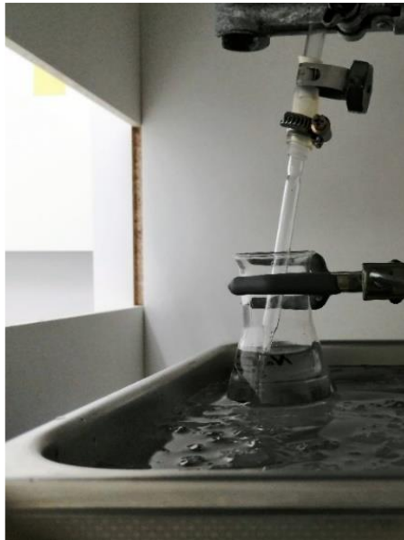
Abbildung 3-4: Versuchsaufbau – Sonolumineszenz, (Eigene Aufnahme)
