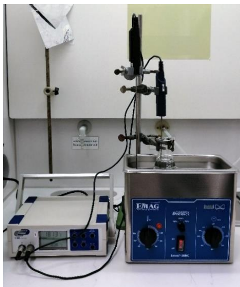
Abbildung 3-2: Versuchsaufbau – Kalorimetrische Messung des Energieeintrags (Eigene Aufnahme)
