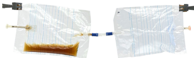
Abb. 4: Trennen von Gas und Flüssigkeit.
