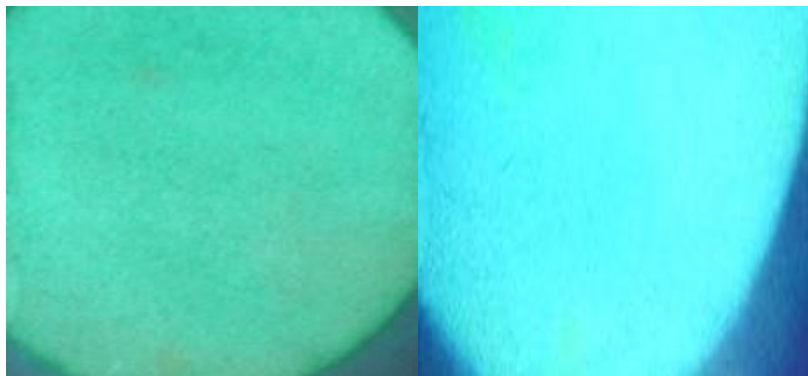
Abbildung 4-14: 3-Pic Lumineszenz Eigenversuch. (links) bei RT; (rechts) bei Abkühlung (Eigene Aufnahme)
