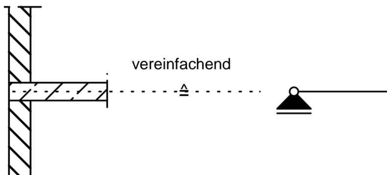
Einfeldträger erfahren die unterschiedlichsten Einzellasten und Linienlasten. Werte für die Auflagerreaktionen und Schnittgrößen wurden in Tabellen zusammengestellt.
