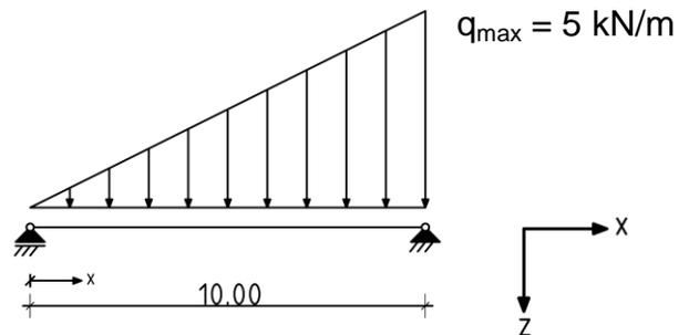
Die Resultierende einer Linienlast geht durch den Schwerpunkt der Lastfläche.
