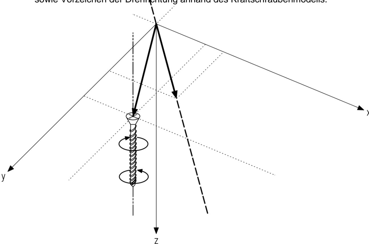
Beispiel zur Belegung des Kraftschraubenmodells
