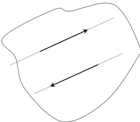
Ein weiterer Sonderfall neben der ZKG ist das sogenannte “äquivalente Kräftepaar“. Dies besteht aus zwei gleichgroßen Kräften, die auf parallelen Wirkungslinien einander entgegen wirken.
