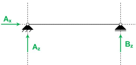
Hier im Beispiel standen 3 Unbekannte zur Bestimmung an. Wählt man z.B. das Auflager A zum Bezugspunkt, so besitzen die Wirkungslinien der Auflagerkräfte  $A_x$  und  $A_z$  keinen Abstand zum Punkt A, also keinen Hebel und bilden demnach kein Moment um Punkt A. Sie treten daher bei der Summe aller Momente um den Punkt A nicht in Erscheinung, was eine Gleichung mit nur einer Unbekannten, nämlich  $B_z$  erzeugt, nach der sofort ausgelöst werden kann.
